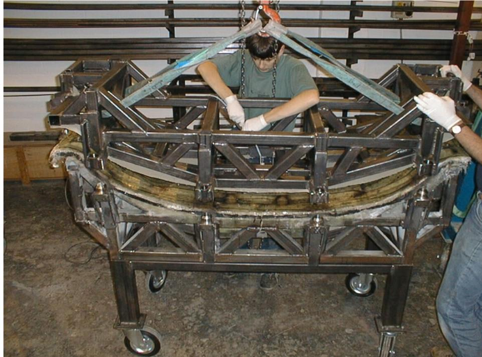
TYPICAL RTM MOULD
